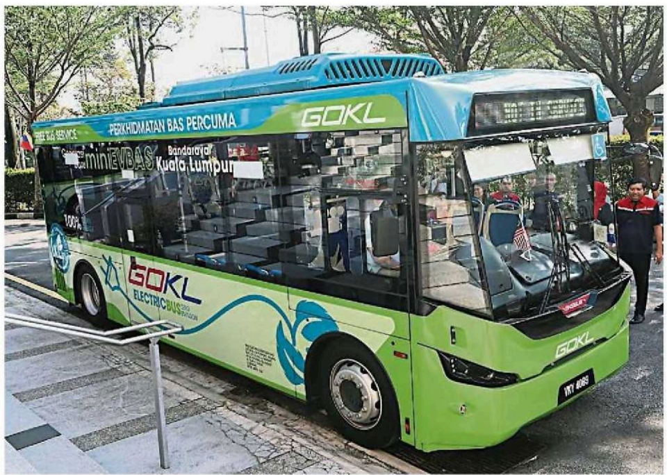
迷你电动巴士车身长约8公尺，比10公尺的普通巴士短，方便在窄小的路段行驶和转弯。(黄志汉摄)
