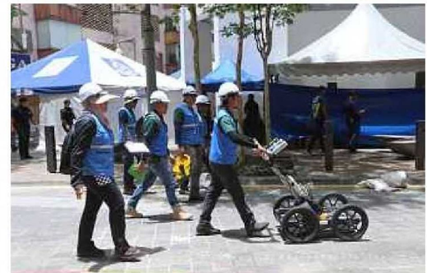
JABATAN Mineral dan Geosains menggunakan Ground Penetrating Radar (GPR) untuk menilai integriti tanah.
